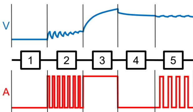
Trinn 1 / Batterikontroll: Etter valg av lademodus kontrollerer laderen statusen på batteriet.
