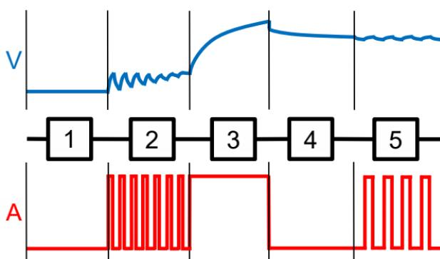
Passo 1 / controllo batteria: dopo aver selezionato la modalità di ricarica, il caricabatteria controlla lo stato della batteria.
