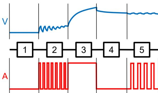
Schritt 1 / Batterieprüfung: Nach Auswahl des Lademodus überprüft das Ladegerät den Status der Batterie.
