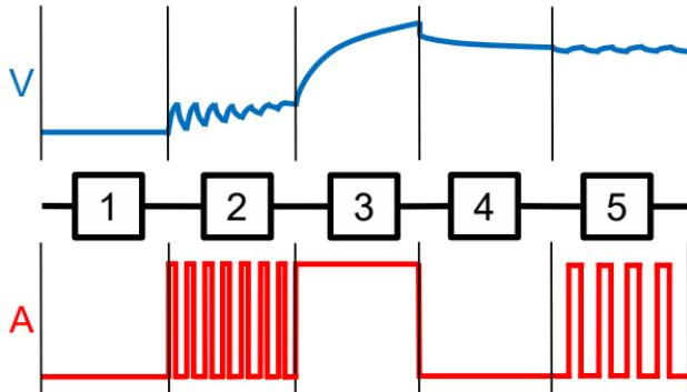
Étape n° 1/ Vérification de la batterie : après avoir sélectionné le mode de charge, le chargeur vérifie l'état de la batterie.
