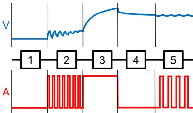
Stap 1/Accucontrole: nadat de oplaadmodus is gekozen controleert de oplader de status van de accu.
