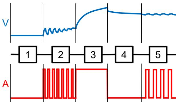
Paso 1/Comprobación de la batería: después de seleccionar el modo de carga, el cargador verifica el estado de la batería.
