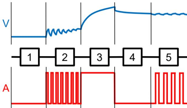
Krok 1 / Kontrola akumulatora: po wybraniu trybu ładowania ładowarka sprawdza stan akumulatora.
