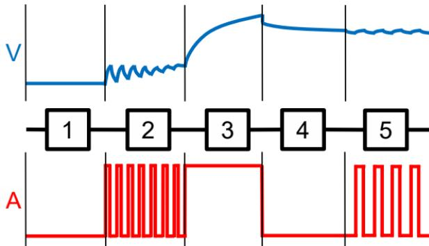
Passo 1/ Verificação da bateria: Depois de selecionar o modo de carregamento, o carregador verifica o estado da bateria.
