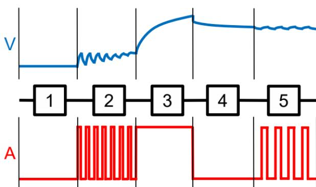
Steg 1/batterikontroll: När laddningsläget har valts kontrollerar laddaren batteriets status.
